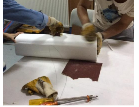
Resim 2.1.2 Kanat Kesimi ve Gövde Zımparalama
