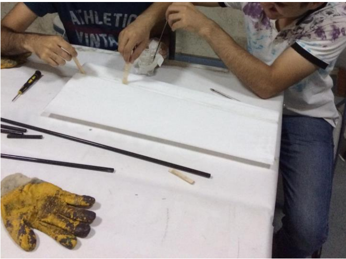
Resim 2.1.4 Kanat ve Kuyruk Karbon Fiber Montajı
