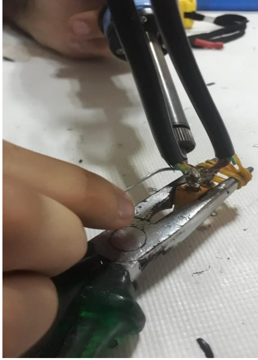
Resim 4.2.2 Kablolu Sigortanın Lehimlenmesi
