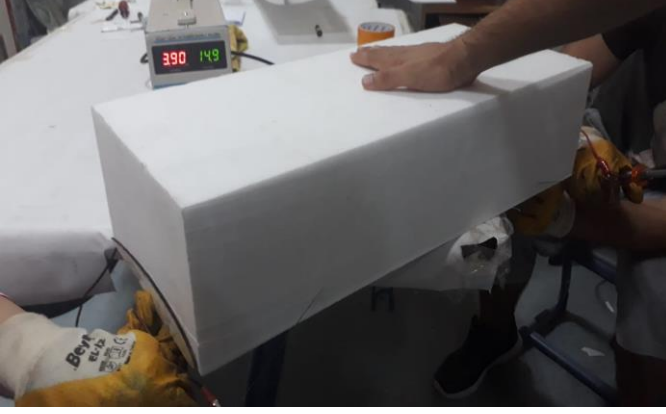
Resim 2.1.2 Kanat Kesimi ve Gövde Zımparalama
