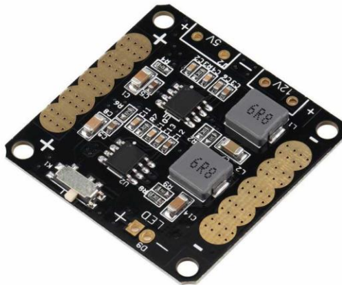
Şekil 2.8. F18057/8 Drone Güç Dağıtım Panosu
