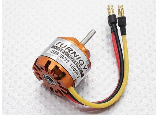
Şekil 2.6. Örnek Bir Fırçasız Motor
