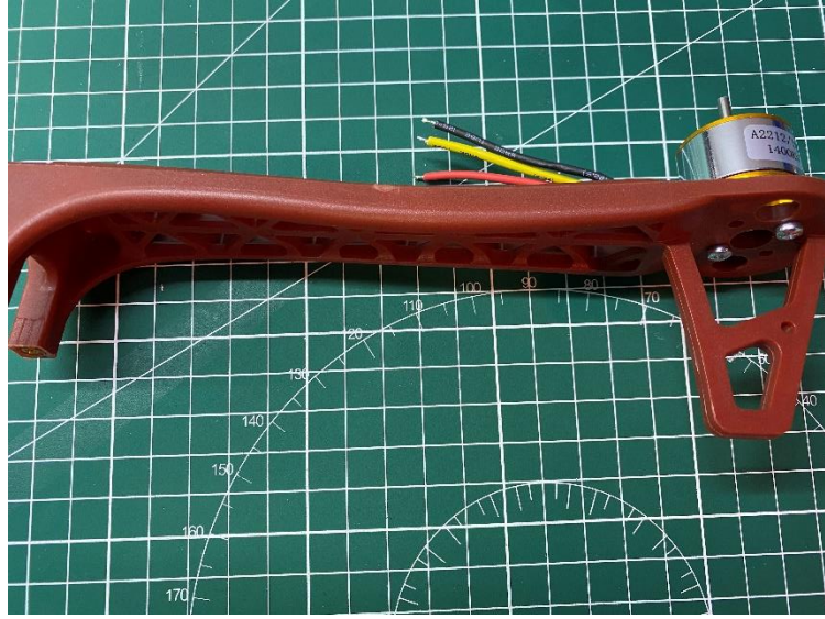
Şekil 4.3a. Kollara motor montajı
