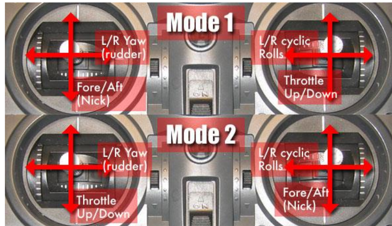
Şekil 2.11. Mode-1 ve Mode-2 Kumandaların Farkı
