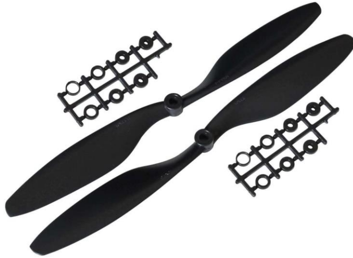
Şekil 3.8. 1045 Siyah Plastik CW/CCW Pervane Seti
