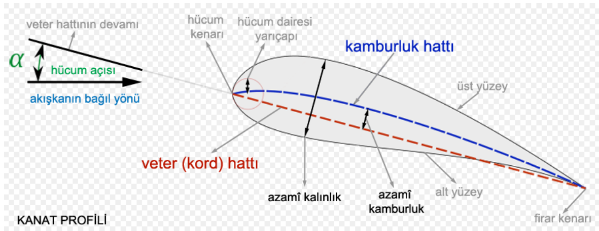
Şekil 3.3. Kanat Profili
