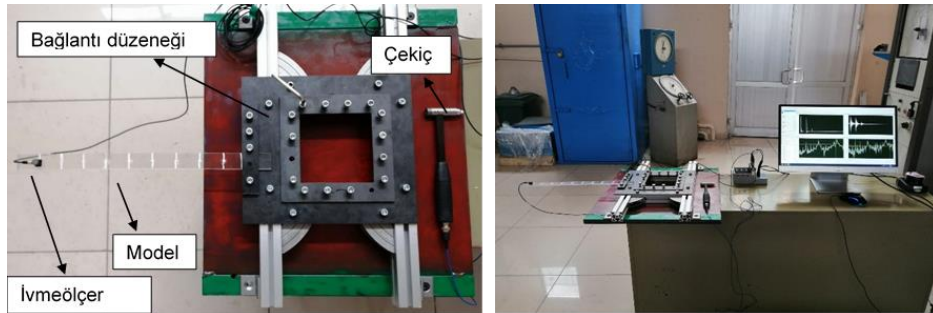
Şekil 2.19. Modal analiz deney düzeneği
