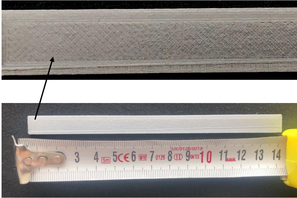
Şekil 2.22. 3 Boyutlu yazıcıda üretilen küçültülmüş model
