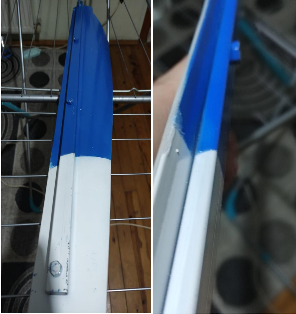
Şekil 7. Türbin kanadı destek profili
