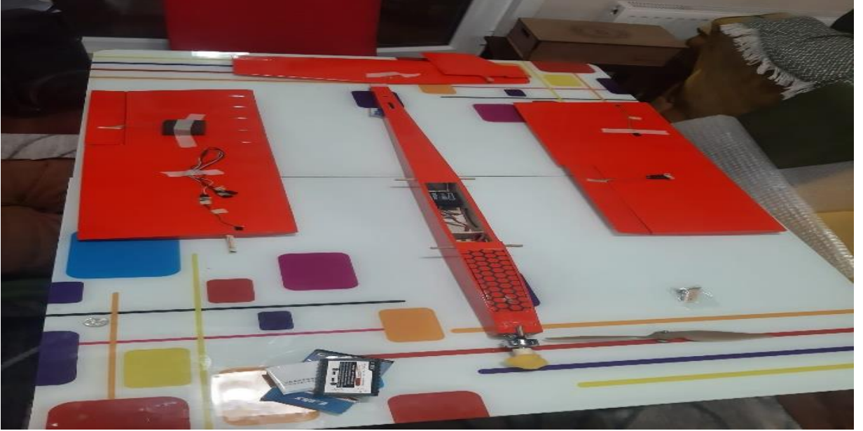
Şekil 11 : Servo Motorların Kanada Takılması
