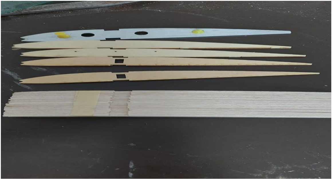
Şekil 2 : Kesilen Kanat Profili (20 Adet)
