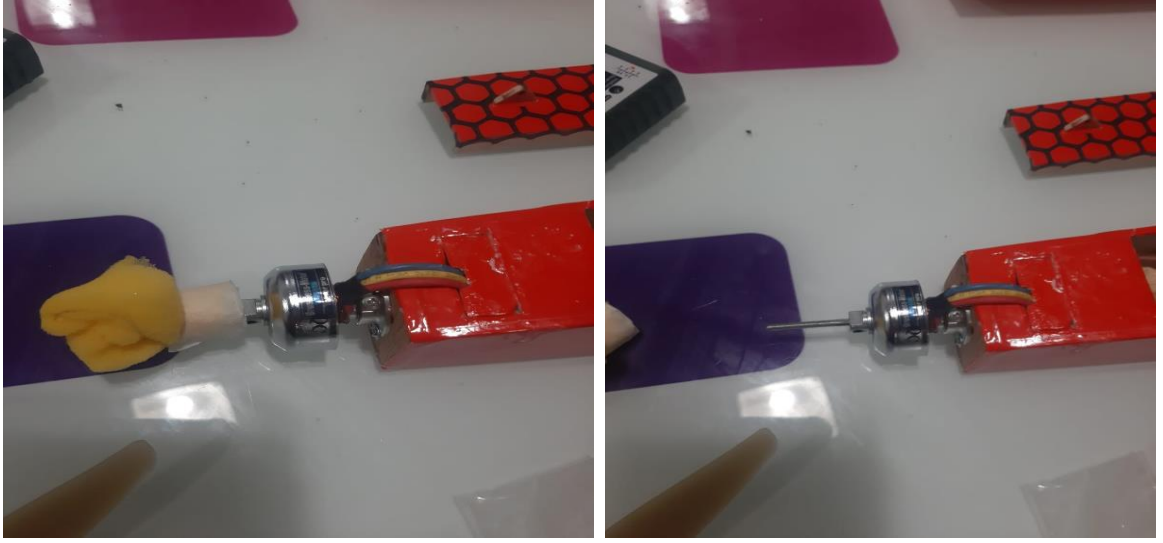
Şekil1 9 Fırçasız DC Motorunun Uçağa Montesi
