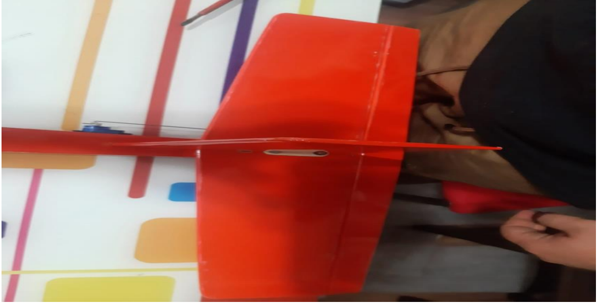
Şekil 12 : Servo Motorların Kuyruğa Takılması
