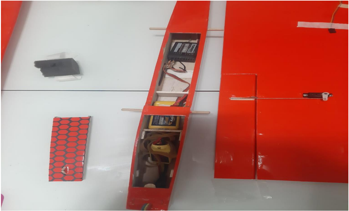
Şekil1 10 : İtki Elemanları Yerleştirilmesi
