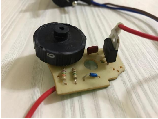
Şekil 4.7 Tasarımda kullanılan DC devre sürücü
