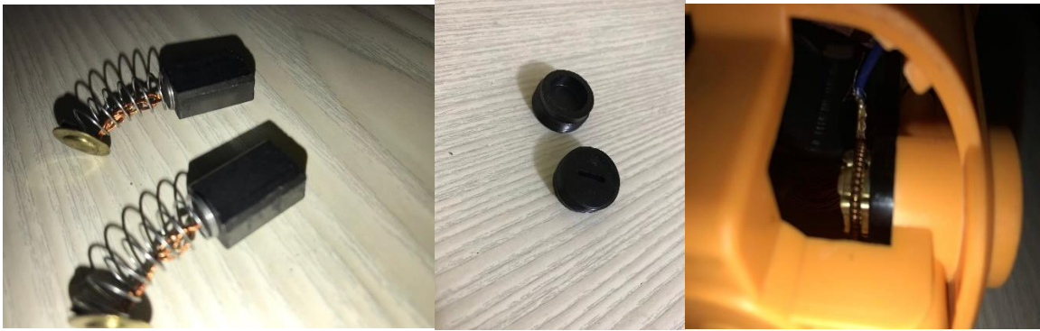
Şekil4.1 Kömürler, koruyucu düğmeler ve yuvadaki konumları
