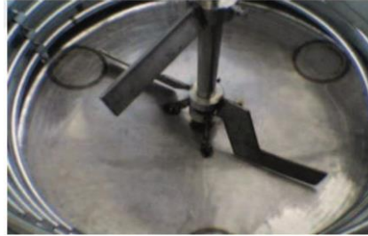
Şekil 1.12. Uçkur tip karıştırıcı
