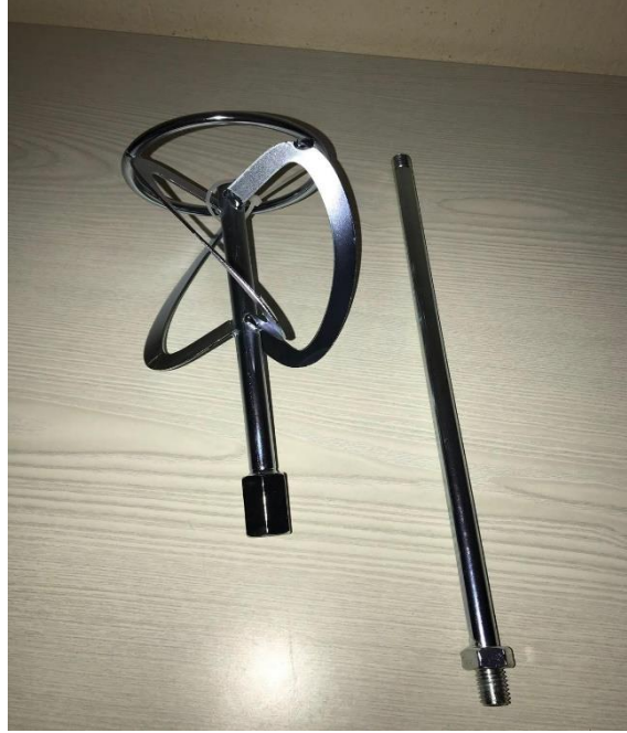
Şekil4.5 Karıştırıcı uç ve uzatma mili
