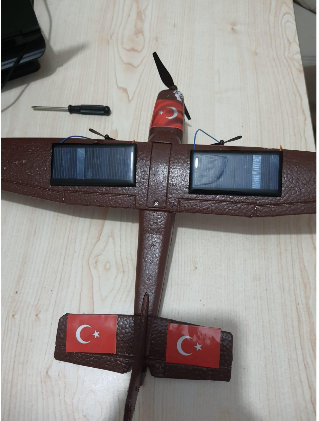
ŞEKİL : 15 MONTAJI TAMAMLANMIŞ İHA NİN ÜST GÖRÜNÜŞÜ
